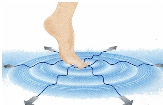
On voit que la forme de l'onde est telle qu'*en tout point, une surface d'onde est normale à la direction de propagation*. S'il n'y a pas d'obstacle, l'onde se propage à la même célérité à partir du point d'émission de l'onde : les surfaces d'onde sont donc des cercles, et les directions de propagation sont les rayons.
